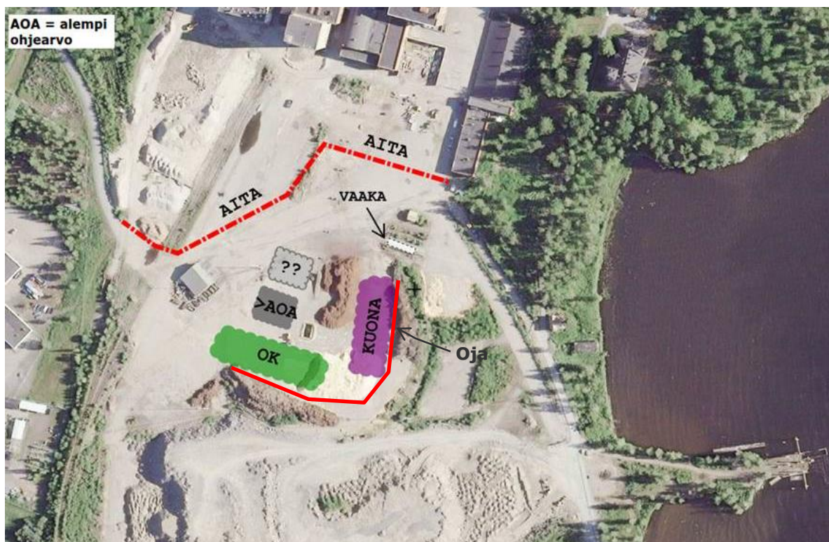
Kuva 18. Kaivumassojen välivarastointialue kunnostustyön aikana. Kuvassa esitettyjen välivarastokasojen sijainnit ovat viitteellisiä.
