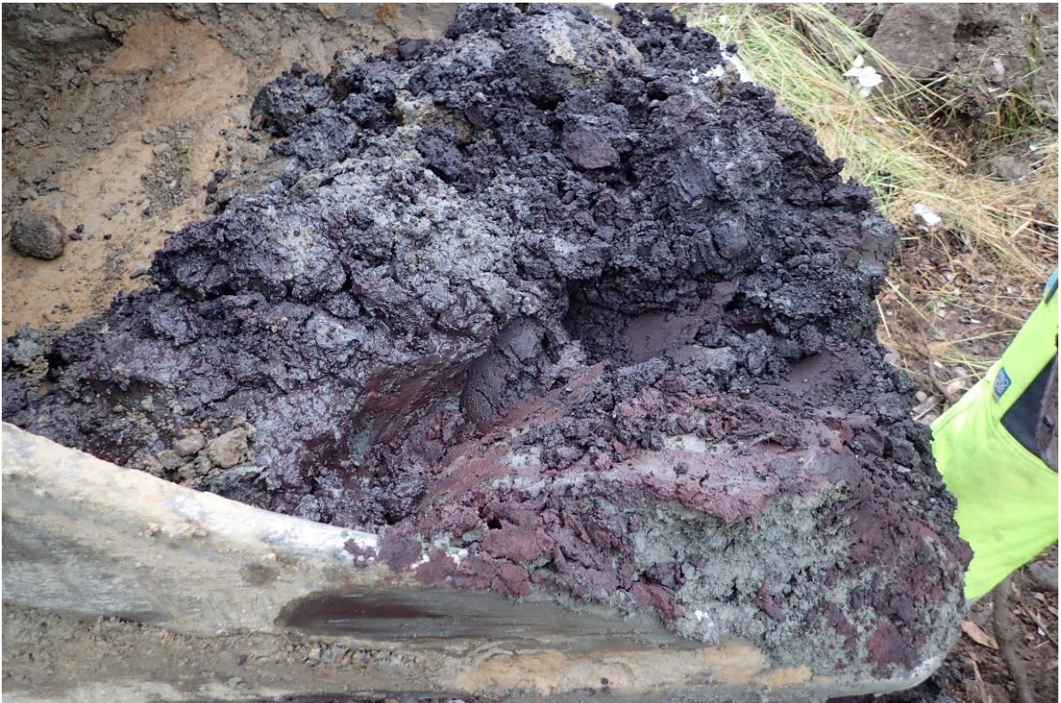
Kuva 4. Alueelle läjitetty rikkikiisukuona on väriltään mustaa/tumman violettia.
